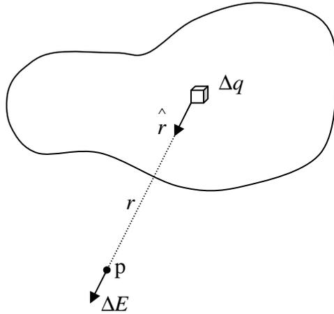
الشكل (8-17) : المجال الكهربائي في النقطة  $p$  الناشئة عن توزيع متصل للشحنة الذي يمثل المجموع الاتجاهي للمجالات  $\Delta E$  الناشئة عن جميع عناصر الشحنة  $\Delta q$ .
