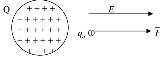
الشكل (1-8): شحنة اختبارية موجبة  $q_o$  موضوعة قرب جسم كروي يحمل شحنة موجبة فائضة Q ويظهر اتجاه المجال الكهربائي  $\vec{E}$  بنفس اتجاه القوة الكهربائية  $\vec{F}$  المؤثرة على الشحنة  $q_o$ .
