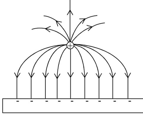
الشكل (8-8) : خطوط القوة الكهربائية حول قضيب سالب الشحنة وفيه الشحنات السالبة متجمعة قرب السطح بسبب انجذابها بالشحنة الموجبة.
