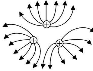
الشكل (8-9) : خطوط القوة الكهربائية حول ثلاث شحنات موجبة متكافئة المقدار.
